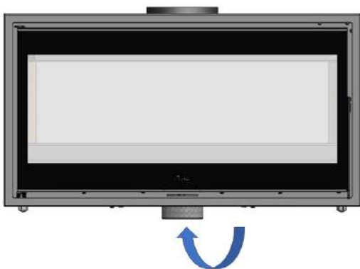
Figura nº11 - Condução do ar para a câmara de combustão Verona 800-1000
