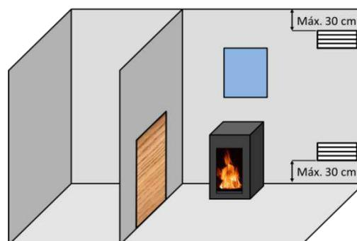
Figura nº3 - Esquema orientativo para grelhas de arejamento
