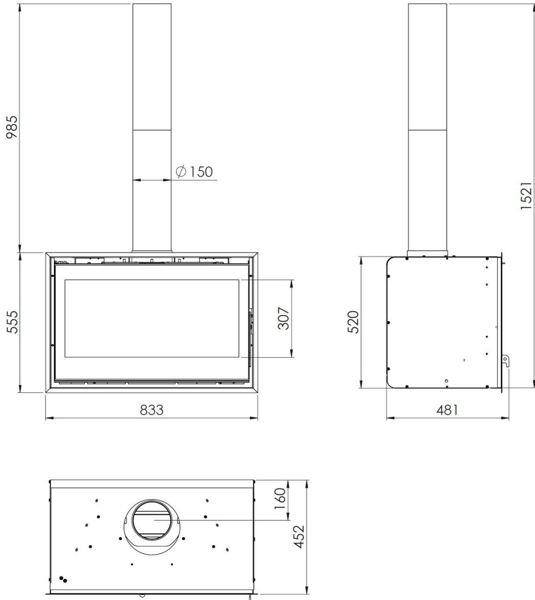
Figura nº2 - Dimensões em mm do aparelho AROA 800 A+
