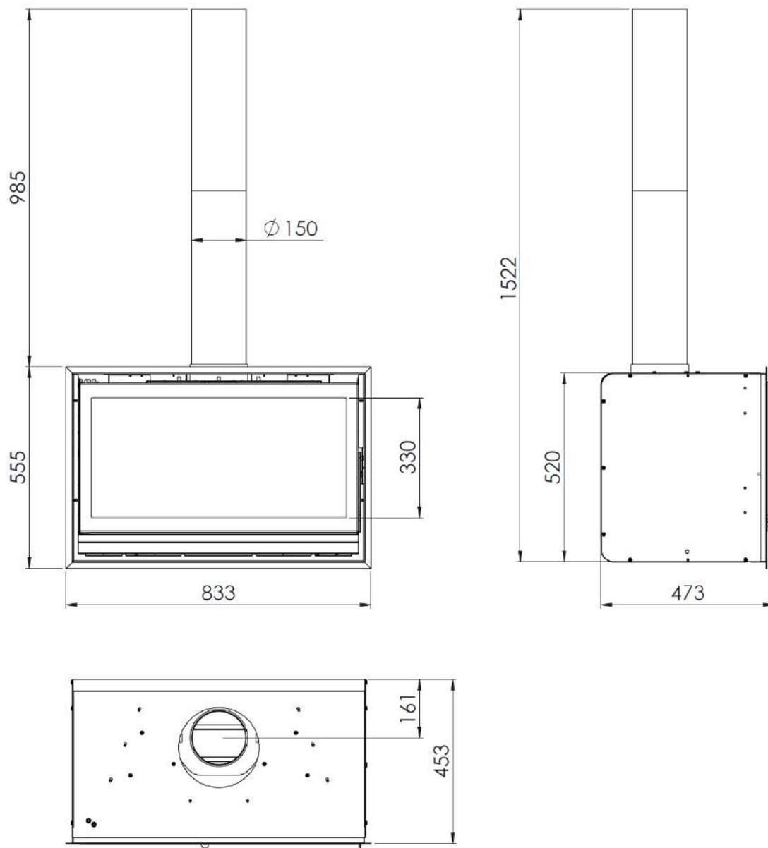
*Figura nº1 - Dimensões em mm do aparelho IC-800 A+*
