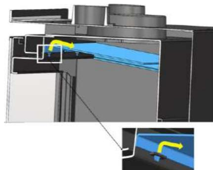
*Figura n°9 - Desmontagem defletor superior*
