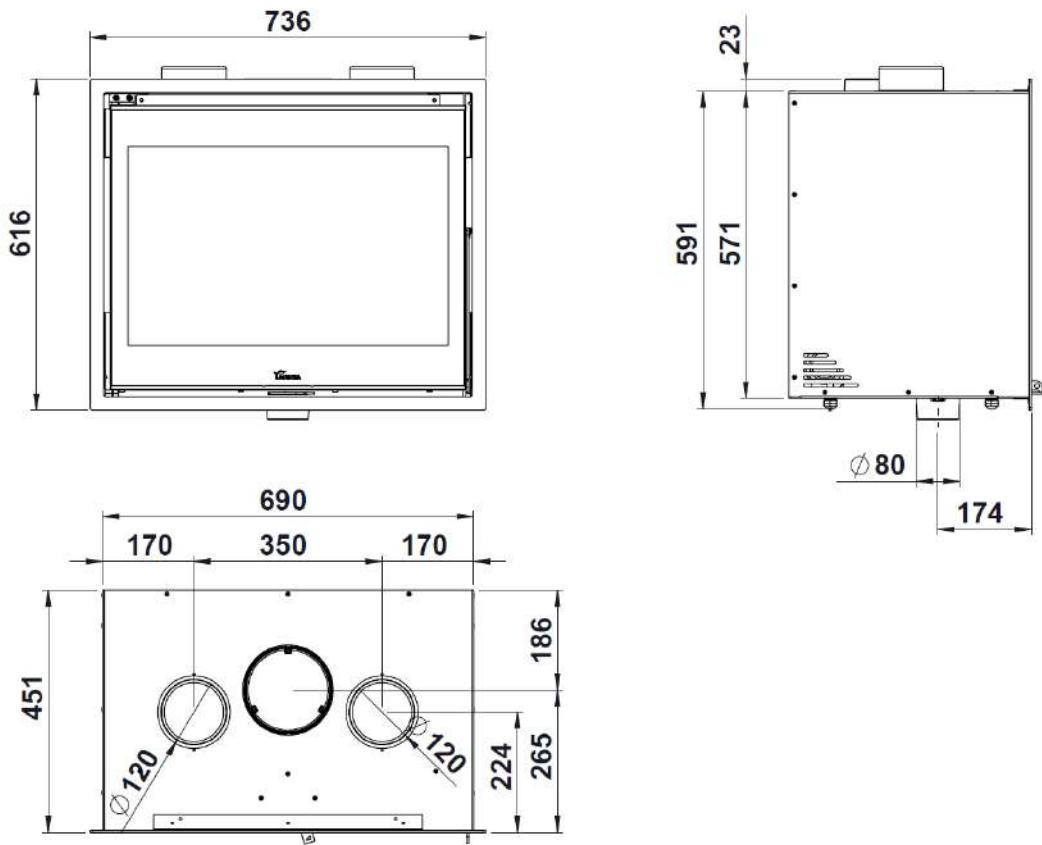
Figura n°1 - Dimensões em mm do aparelho LOIRE 700
