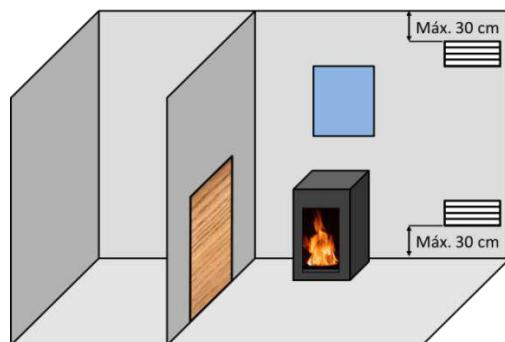
Figura nº4 - Esquema orientativo para grelhas de arejamento
