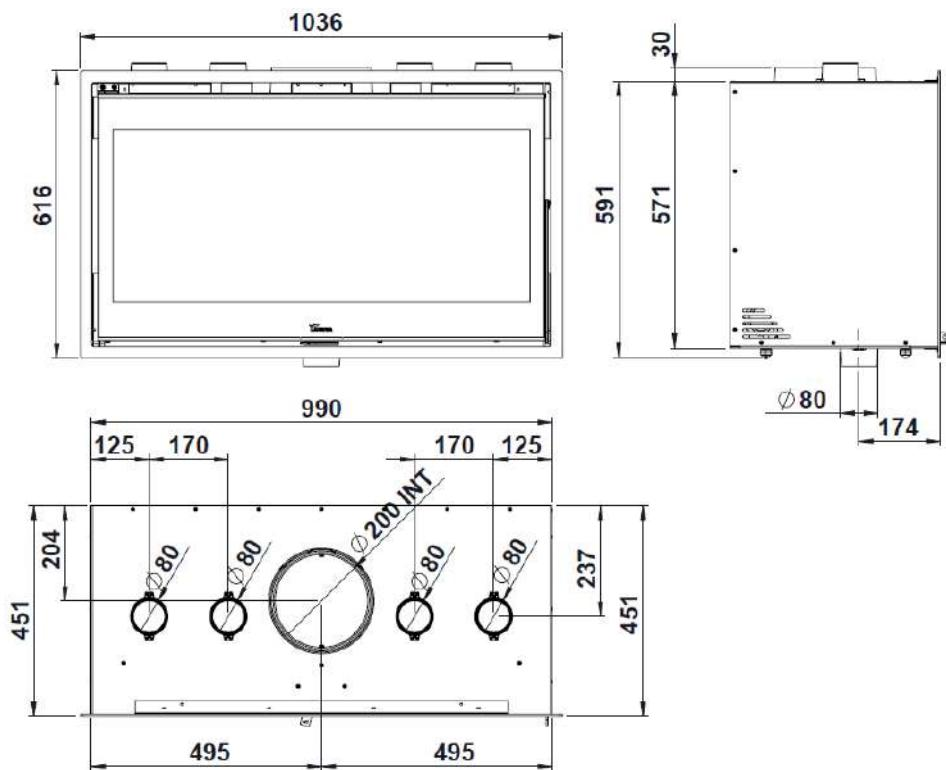
Figura n°3 - Dimensões em mm do aparelho LOIRE 1000
