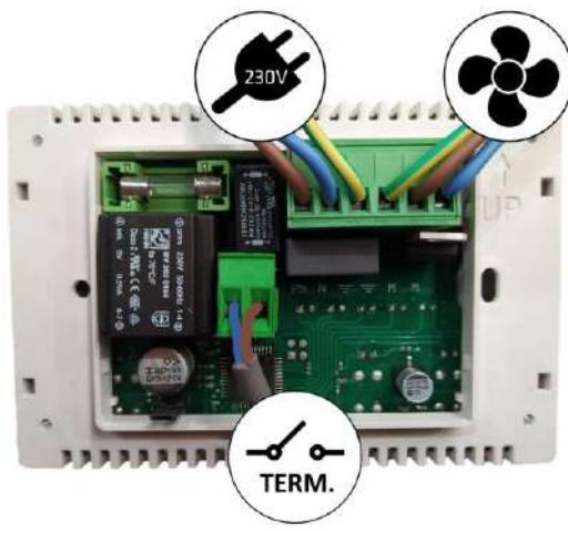
*Figura nº1 - Ligações a realizar no potenciômetro*
