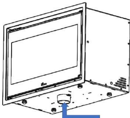
*Figura nº7 - Condução de ar para câmara de combustão*
