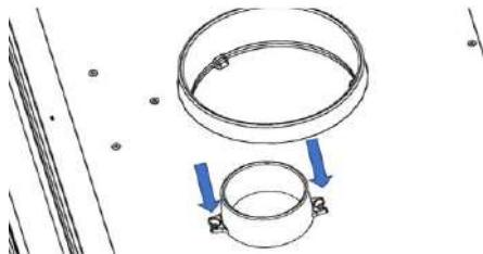
*Figura nº13 - Aparafusar o tubo na parte traseira.*
