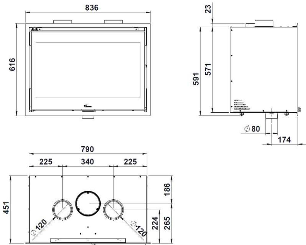
Figura n°2 - Dimensões em mm do aparelho LOIRE 800
