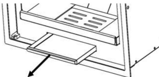
Figura n°7- Retirada da cinza
