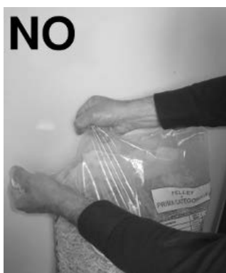
Fig. 20 - Abertura incorreta de saca de pellets
