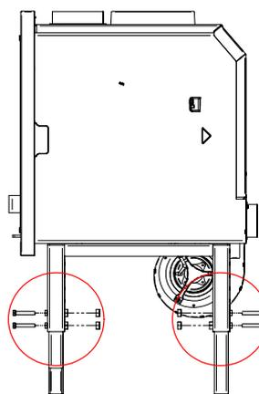
Para montar a bancada basta aparafusar, com o auxílio de 4 parafusos M8 x 16 mm e as 4 arruelas, as duas estruturas independentes de cada lado da base do aparelho, coincidindo os vãos entre a base (com porca rebite) e a estrutura do próprio banco.
