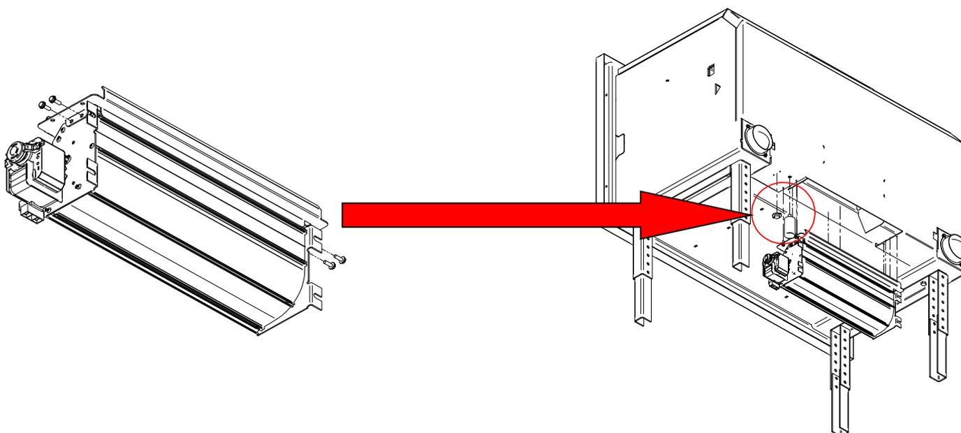
Para montar a turbina tangencial ao equipamento é necessário instalá-la previamente no bocal de adaptação, parafusando-a lateralmente. Ao mesmo tempo, devemos aparafusar o termostato ao equipamento, processo que pode ser feito a qualquer momento durante a montagem do kit adquirido.
