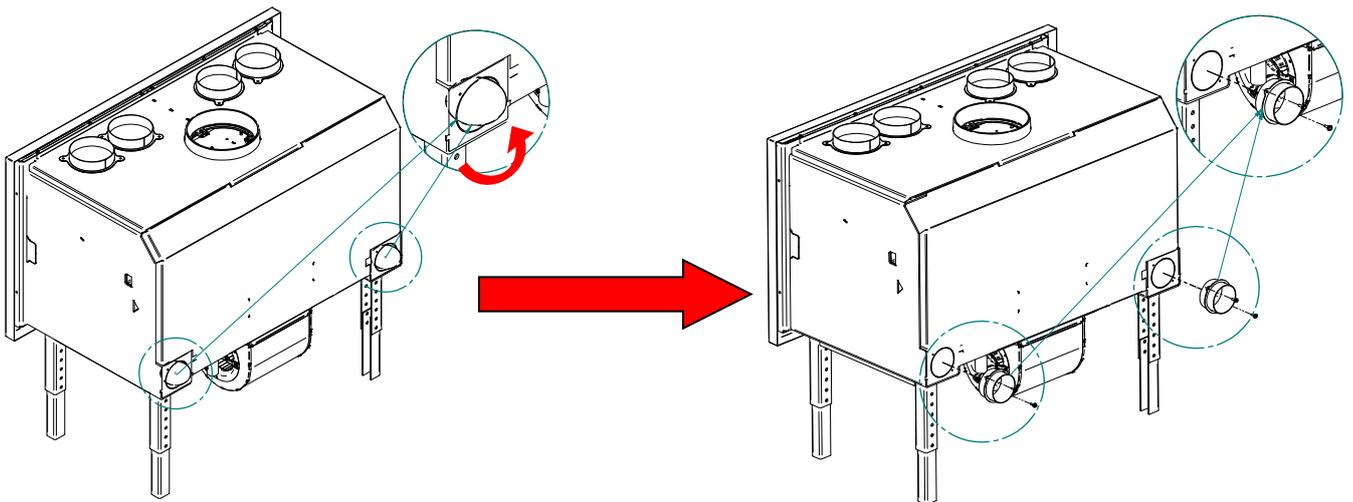
Para a correta instalação do kit de canalização de ar primário é necessário retirar os furos pré-cortados que apresentam os furos nos quais é fixado cada um dos bicos. Depois de removidos, os bicos se encaixam na abertura e são parafusados nos orifícios dos cantos na parte traseira do equipamento.
