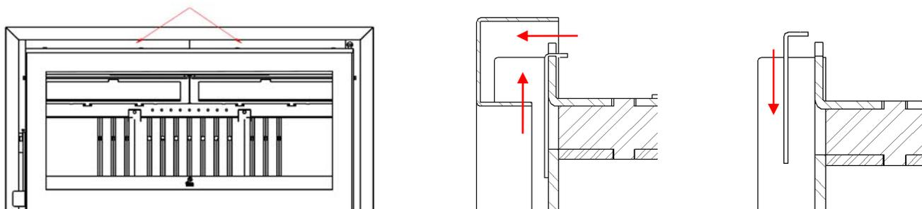
Poderá ver como as saídas previstas para as tubagens são tapadas para evitar perdas de caudal por não serem utilizadas e assim otimizar o funcionamento dos nossos equipamentos. Para prosseguir com a instalação do(s) bico(s) canalizador(es) em nosso equipamento devemos seguir os seguintes passos simples:
