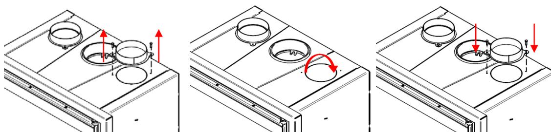
Abaixo mostramos um exemplo gráfico onde você pode ver o sistema de montagem dos ventiladores axiais pertencentes ao Kit de Dutos. Da mesma forma, você deve ter em mente que na lateral do seu equipamento encontraremos o cabo elétrico que deve ser conectado à rede. A conexão correta à instalação de aterramento é essencial.
