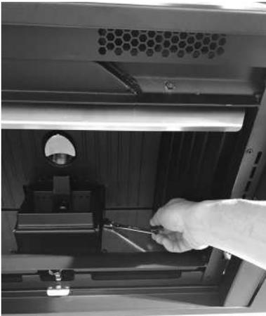
*Fig. 31 - Remoção das bases*
