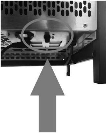
**Fig. 23 - Rearramento manual: situado em baixo da estufa (FRAME 3)**
