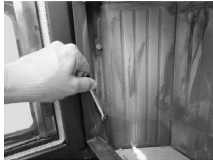
*Fig. 32 - Remoção de parafusos*
