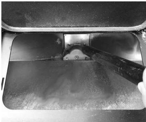
*Fig. 30 - Limpeza do reservatório e da rosca sem fim*
