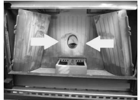
*Fig. 33 - Remoção dos ferros fundidos laterais*
