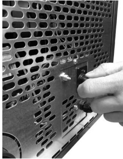
**Fig. 24 - Rearramento manual: MODO AIRTIGHT**
