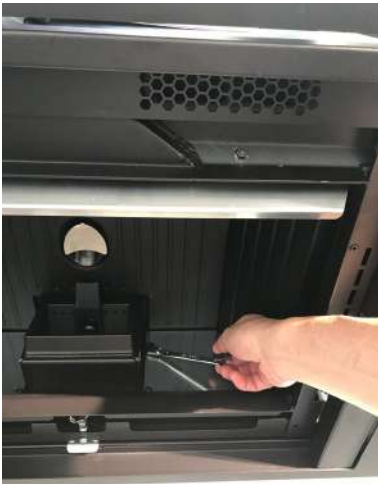
Fig. 36 - Remoção das bases
