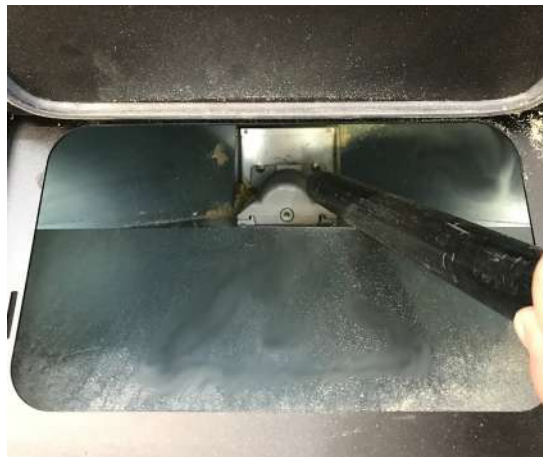
Fig. 35 - Limpeza do reservatório
