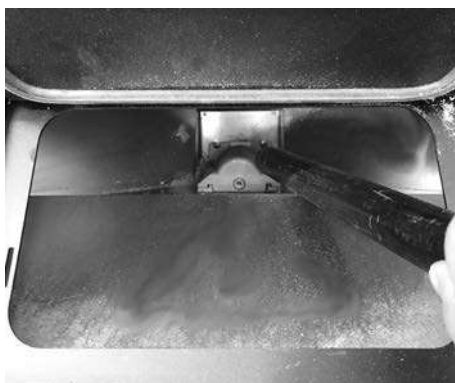
Fig. 27 - Limpeza do reservatório
