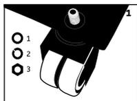
**PASSO 1** Instale, se necessário, as rodas. A correta ordem de montagem, vista de baixo, é: Parafuso - Roda - Marino - Anilha - Anilha de Pressão - Porca. Use a chave fornecida para apertar.
