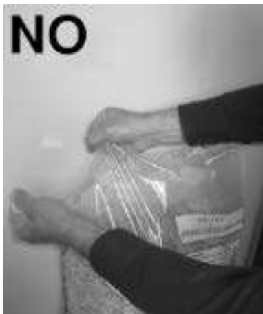
Fig. 24 - Abertura incorreta de saca de pellets
