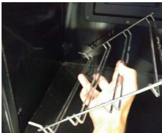
Figura nº21 - Retirada dos suportes das hastes
