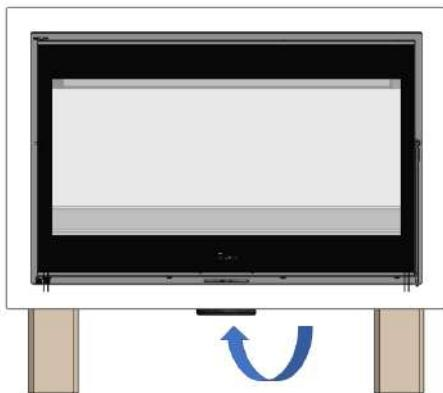
Figura n°5 - Condução do ar para a combustão
