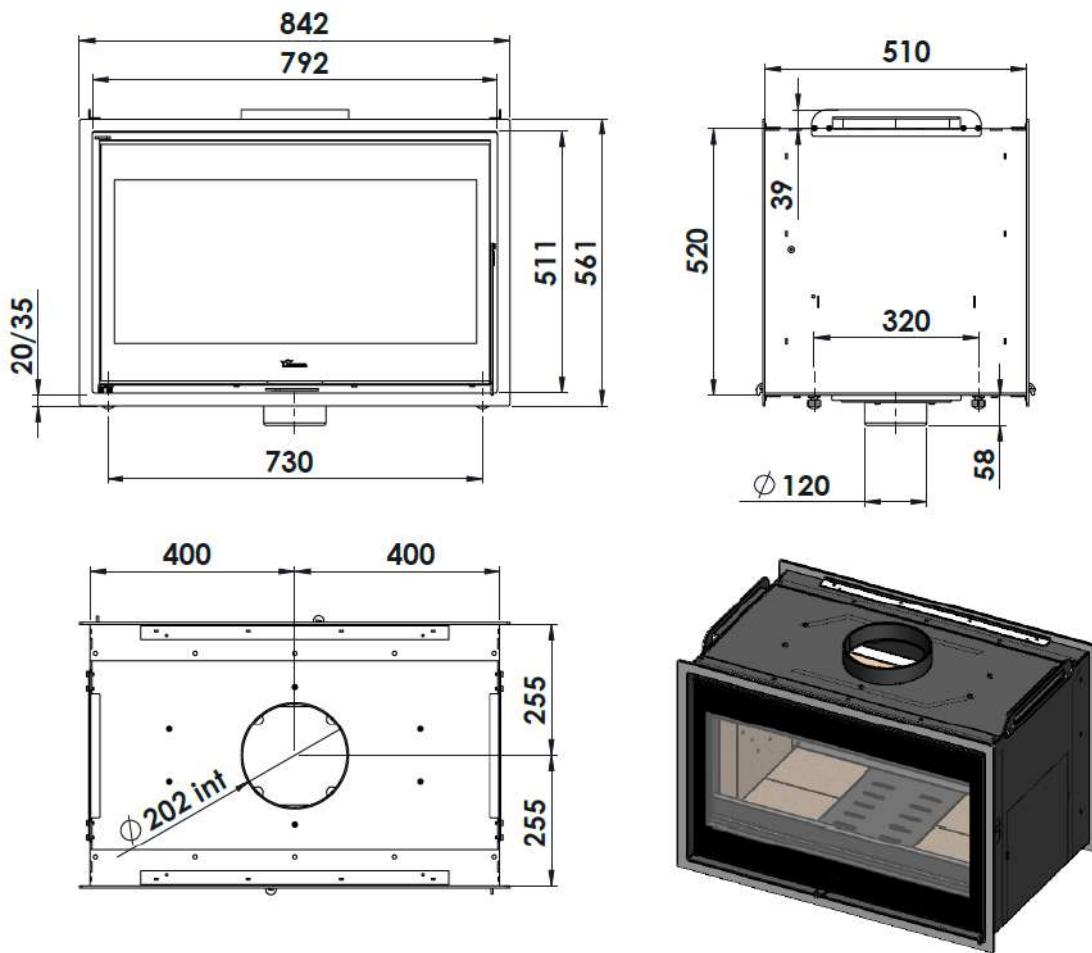
Figura n°2 - Dimensões em mm do aparelho Nickel 800
