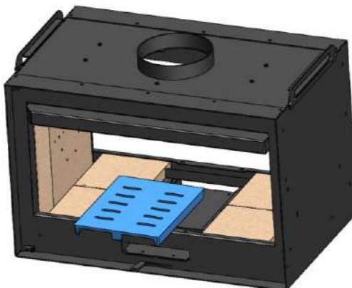
Figura nº17 - Extraímos a grelha ou grilhas (Nickel 1000) de ferro fundido
