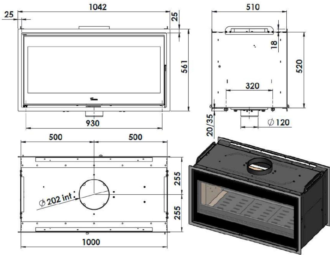
Figura nº3 - Dimensões em mm do aparelho Nickel 1000
