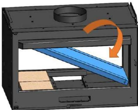
Figura n°20 - Solte o defletor e retire-o da fornalha
