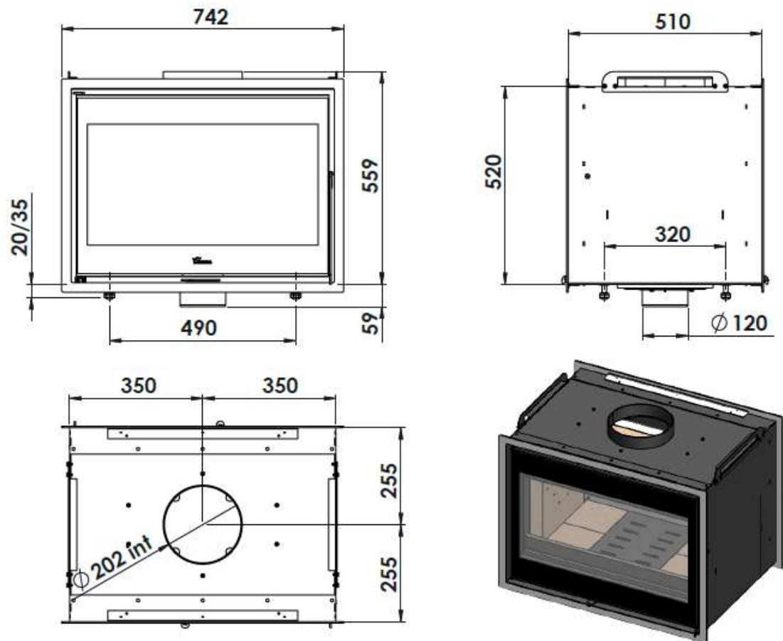
Figura n°1 - Dimensões em mm do aparelho Nickel 700
