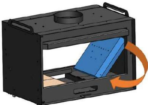
Figura n°19 - Dobramos o refratório lateral para que o defletor caia
