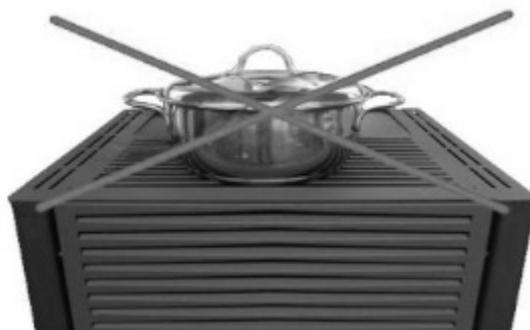
**Fig. 39 - Não cobrir as entradas de ar**
