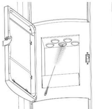
Fig. 21 - Limpeza do carcaça e tubos
