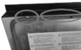
Fig. 27 - Junta deteriorada
