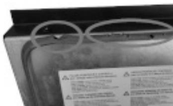
Fig. 27 - Junta deteriorada
