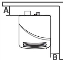
Se il pavimento è costituito da materiale combustibile, si suggerisce di utilizzare una protezione in materiale incombustibile (acciaio, vetro...) che protegga anche la parte frontale dall'eventuale caduta di combustibili durante le operazioni di pulizia.
