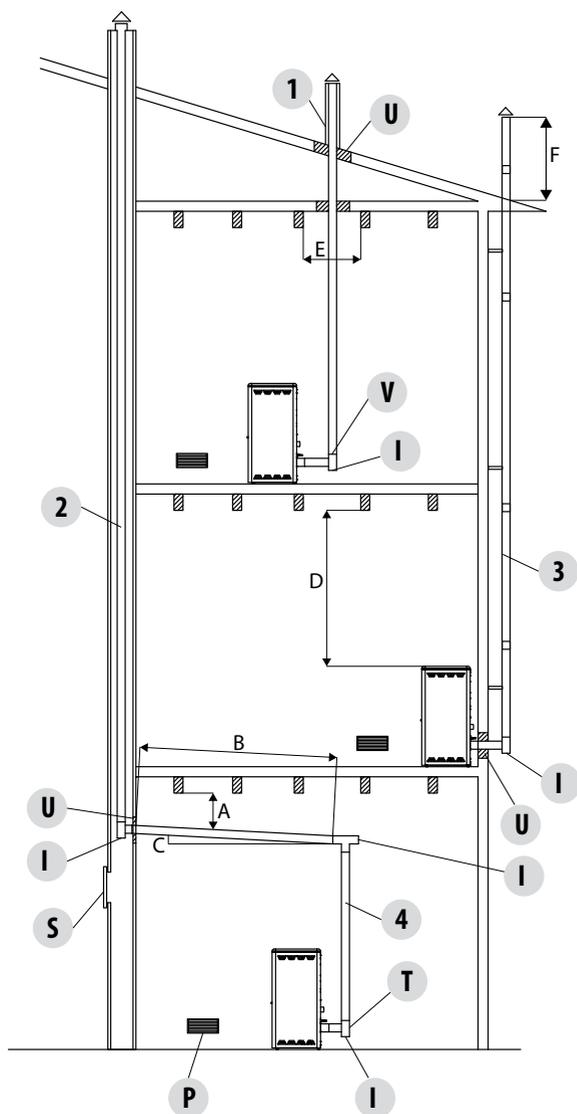
**1.** Installazione canna fumaria  $\varnothing 120\text{mm}$  con foratura per il passaggio del tubo maggiorata di: minimo 100mm attorno al tubo se comunicante con parti non infiammabili come cemento, mattoni, ecc.; oppure minimo 300mm attorno al tubo (o quanto prescritto nei dati targa) se comunicante con parti infiammabili come legno ecc.
