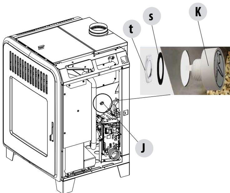
Il sensore pellet è un indicatore di riserva del combustibile con lo scopo di avvisare l'utente che il pellet sta ultimando.
