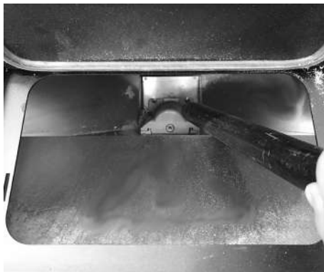
Fig. 22 - Limpeza do reservatório e da rosca sem fim
