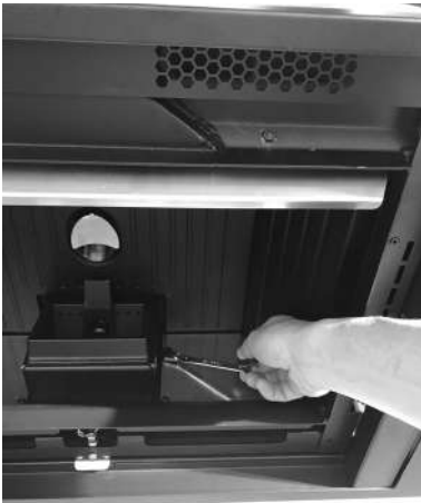
Fig. 31 - Remoção das bases
