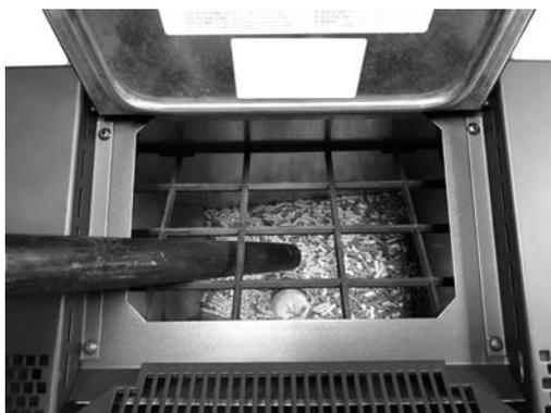
**Fig. 29 - Limpeza do reservatório e da rosca sem fim**
