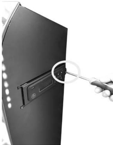
Fig. 2 - Remover o parafuso
