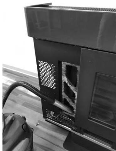
**Fig. 33 - Limpeza da câmara de fumos**
