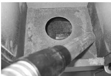
**Fig. 26 - Limpeza do compartimento da gaveta de cinzas**
