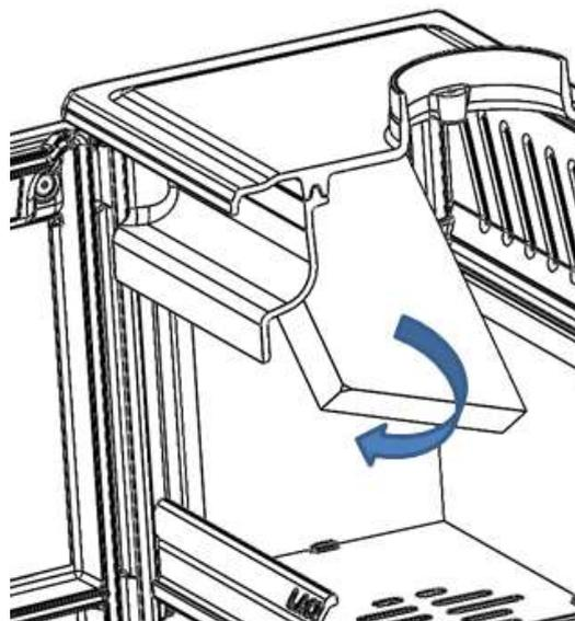
Figura nº13 - Extração dos defletores de vermiculita
