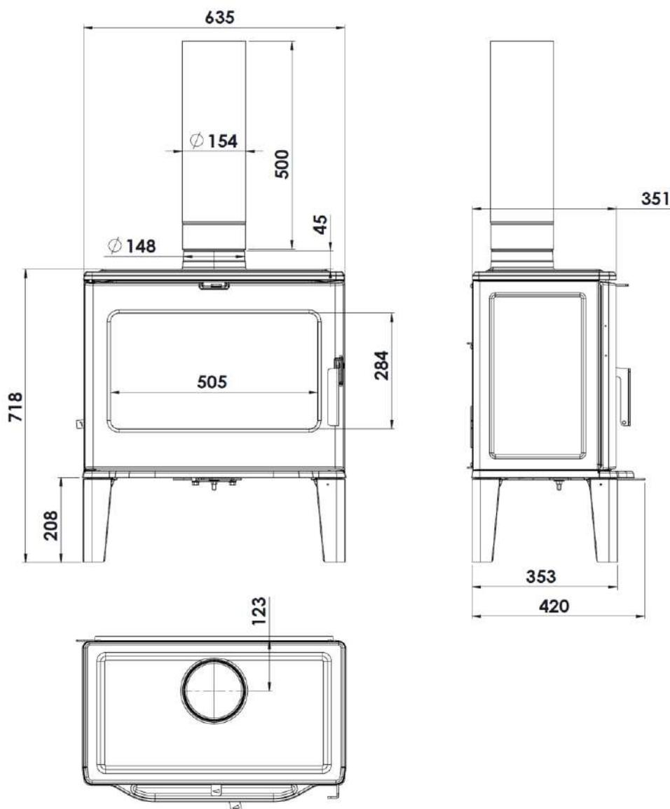
Figura nº1 - Dimensões em mm do aparelho Bidart
